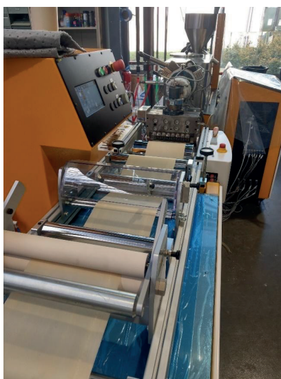
↑ Fig. 2 - Elaboration d'un film à base de PHA en extrusion cast.
