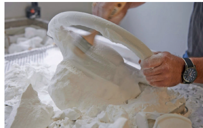
↑ Extraction des pièces à la fin d'un batch de frittage. Source : https://all3dp.com/1/sls-3d-printing-the-ultimate-guide/
