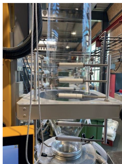
↑ Fig. 3 - Elaboration d'un film à base de PLA en extrusion gonflage (blown).
