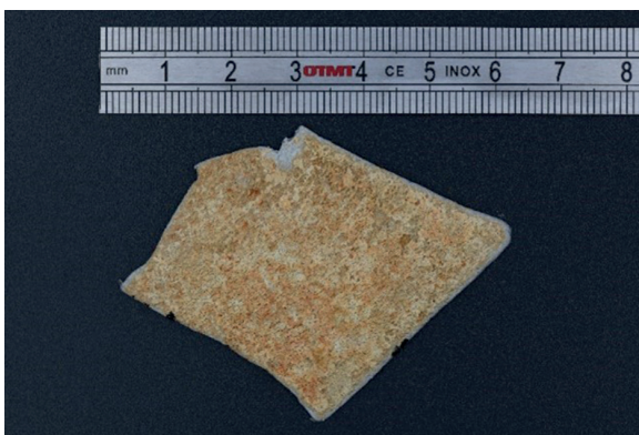
↑ Fig.2 - Exemple d'un fragment de PP retrouvé sur une plage du Morbihan, Bretagne. A gauche : vue globale du débris. A droite : zoom sur la fissuration importante et le changement de couleur en surface indiquant un niveau de vieillissement avancé.
