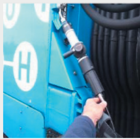
Remplissage des réservoirs en Hydrogène
